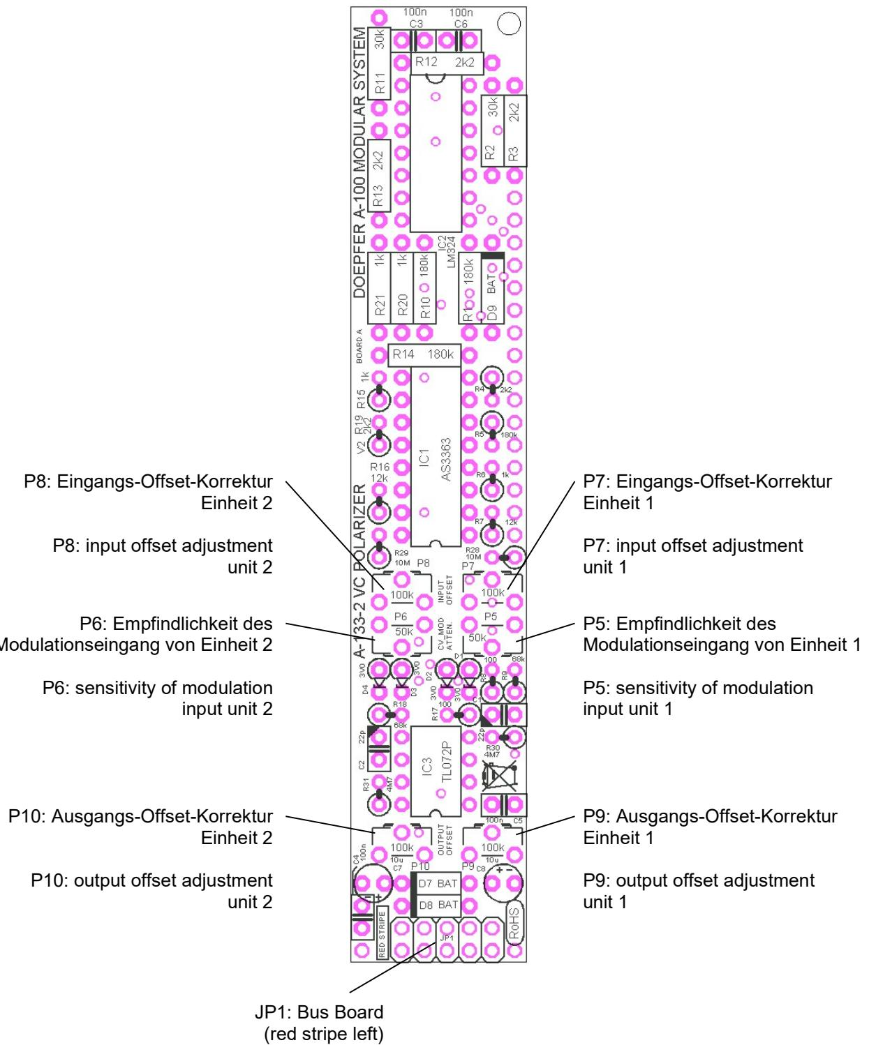
Zusätzlich bei Version 2: Mit Hilfe der Trimmpotentiometer für die Offset-Korrekturen wird die Ausgangsspannung möglichst genau auf 0V einjustiert, wenn keine Signale anliegen (keine Eingangssignal an der Buchse *In* und kein CV-Signal).
