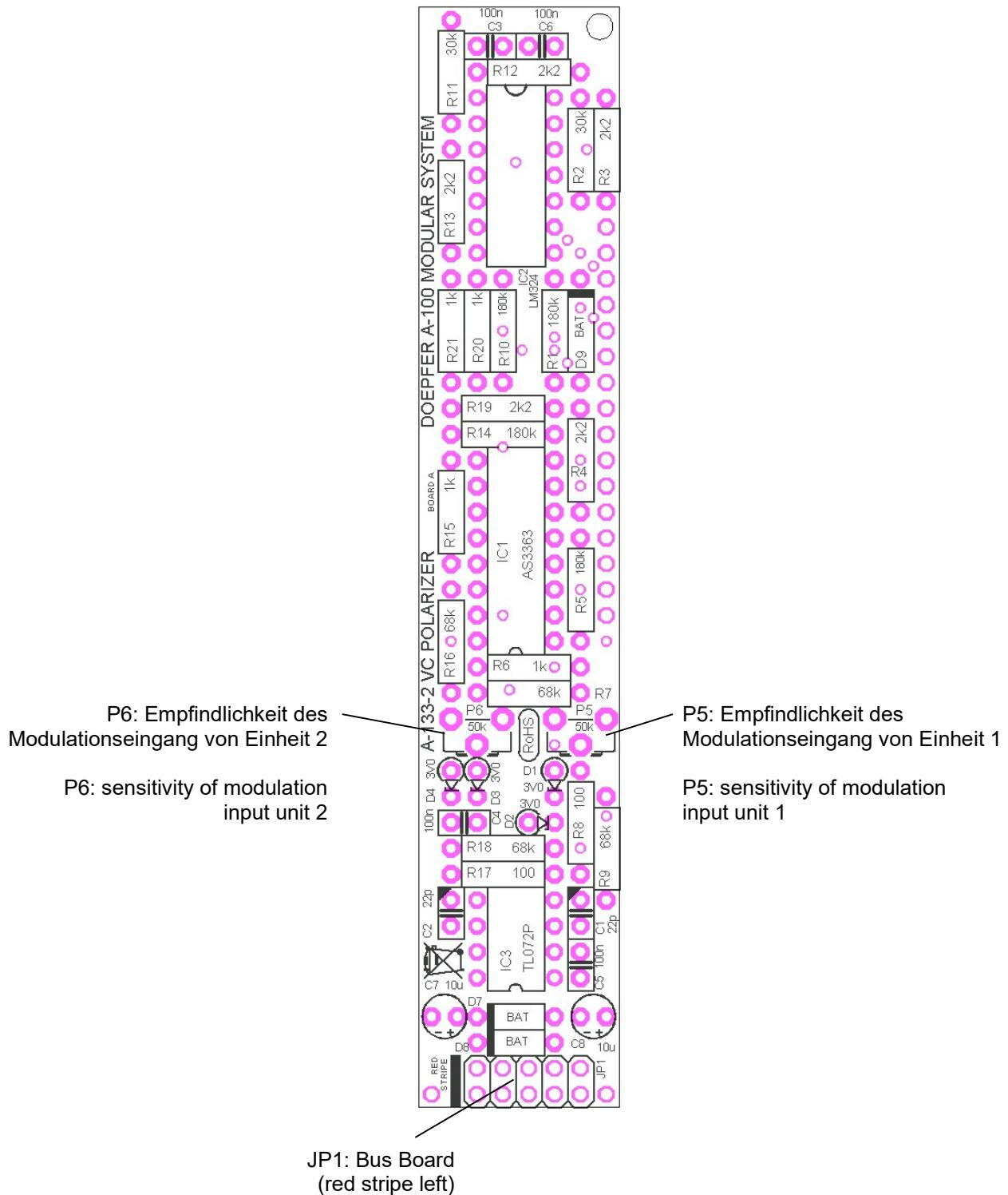
In der Maximalstellung von P5/P6 beträgt der Steuerspannungsbereich an der Buchse Mod ca. -5V...+5V (Auslieferungszustand), in Mittelstellung ca. -10V...+10V.
