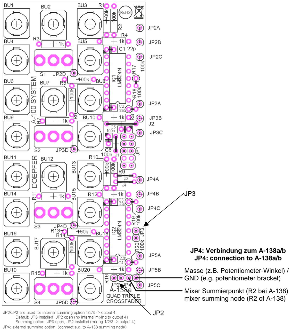
**Wichtig:** Der Jumper JP3 muss beim A-138e aufgesteckt werden, da sonst der 4. Kanal fehlt. JP2 darf nicht gesetzt werden.
