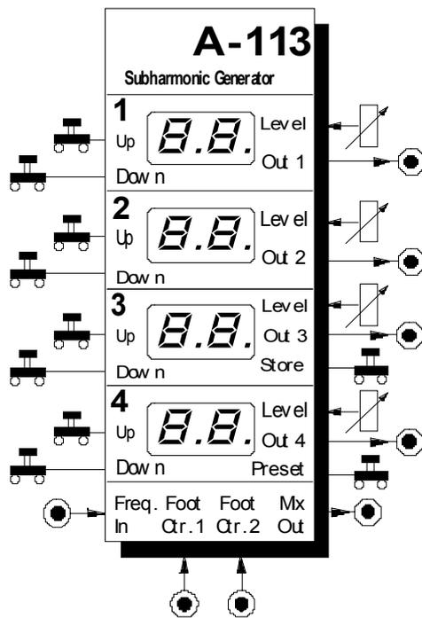
**ACHTUNG!** Das A-113-Modul benötigt eine zusätzliche +5V-Stromversorgung mit 100mA (z.B. eigenes +5V-Netzteil oder +5V-Adapter)
