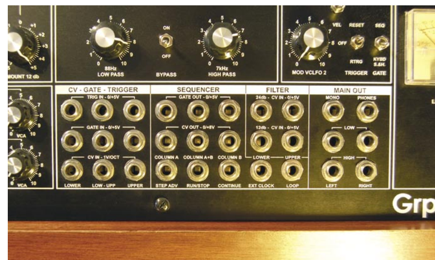
Abb: Die CV/Gate und Audio-Anschlüsse; Rückseitig gibt's MIDI und nochmals Audio-Out
