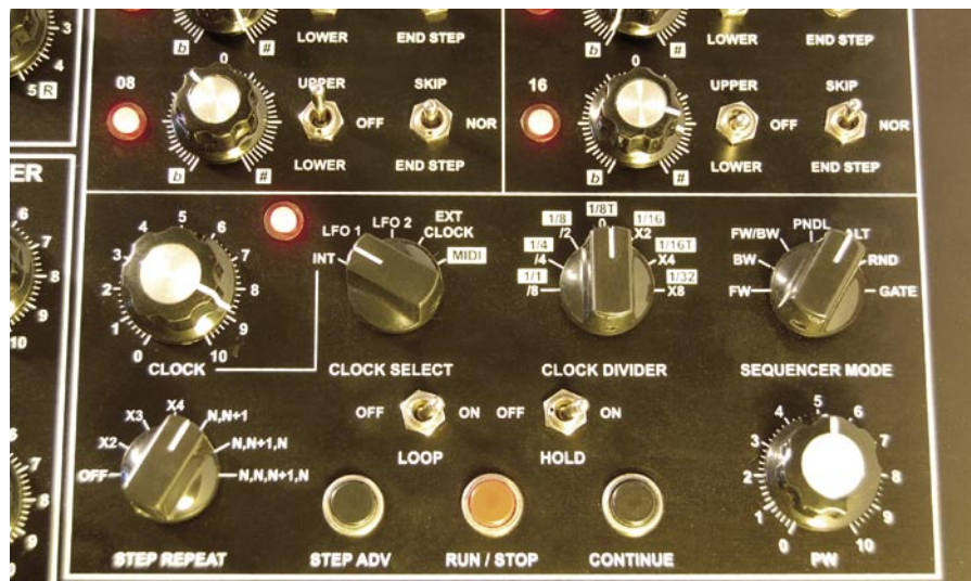
Abb: Mit „GATE“ (rechts außen) passt sich der Sequencer allen eingehenden MIDI Noten an
