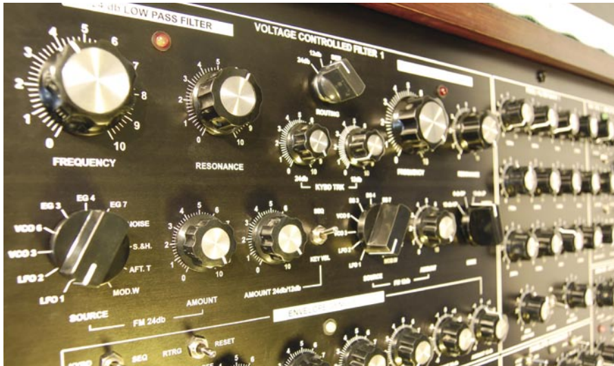
Abb: Jede der beiden Synthesizer-Einheiten verfügt über 2 Filter und eine Filterbank
