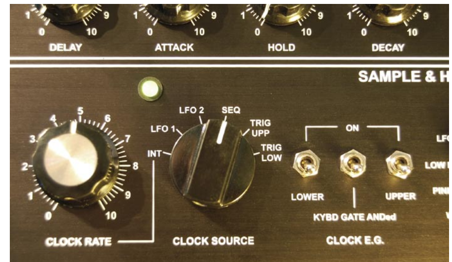
Abb: Sample & Hold kann (unter anderem) mit dem Sequenzer synchronisiert werden
